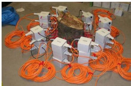
Abbildung 230: Aufbau der SIP-Messung am Baumstamm mit Kernfäule
