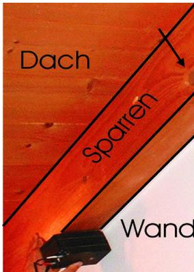
Abbildung 111: Messung mit A1220 an Sparren aus Fichte mit Untersuchung der Bauteilhöhe ( $h = 17$  cm). Der oberflächennahe Ast (Pfeil) beeinflusst die Messungen.
