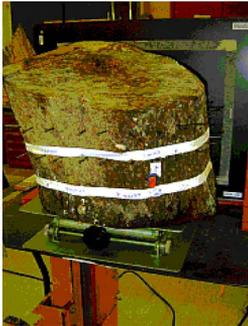
Abbildung 223: Messung am Baumstamm einer Birne mit Kernfäule bei 0°
