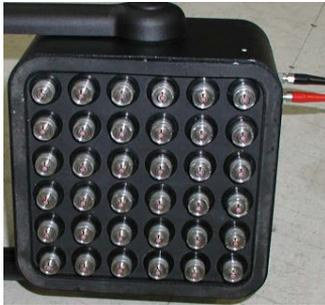
Abbildung 80: Unteransicht des Prüfkopfes A1231 mit Punktkontaktprüfköpfen für Transversalwellen
