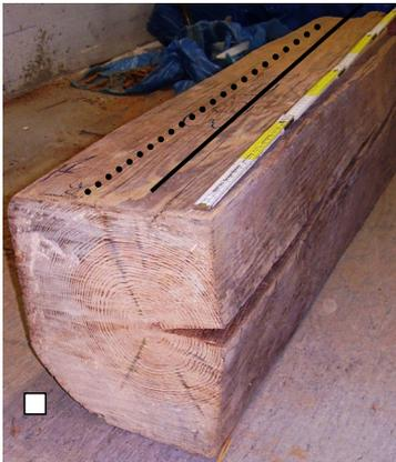
Abbildung 204: Ausgebauter Balken REI03 (25 cm x 21 cm x 90 cm) mit Messlinie in Bauteilmitte und am linken Bauteilrand.
