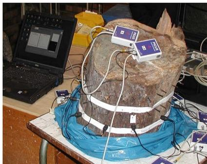
Abbildung 228: Messgerät PICUS am Probekörper mit Sensoren und Rechner
