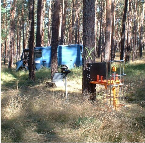
Abbildung 144: Messung mit Blitzröhre (300 kV) und Flachdetektor auf dem Feiversuchsgelände der BAM in Horstwalde an Kiefer, die zur Verifizierung nach der Messung gefällt werden soll.
