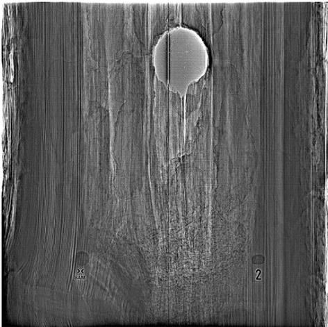
Abbildung 155: Röntgenaufnahme (150 kV) mit Hochpassfilterung von Kiefer mit Innenfäule und Spechthöhle, gesunder Bereich an ungeschädigter Jahrringstruktur am Rand zu erkennen
