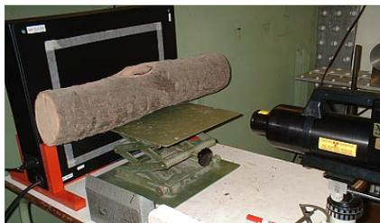
Abbildung 126: Messaufbau mit Röntgenblitzröhre (rechts), links Agfa Flachdetektor (Typ "DirectRay am-Se") und Baumstamm mit Schadstelle am Astansatz
