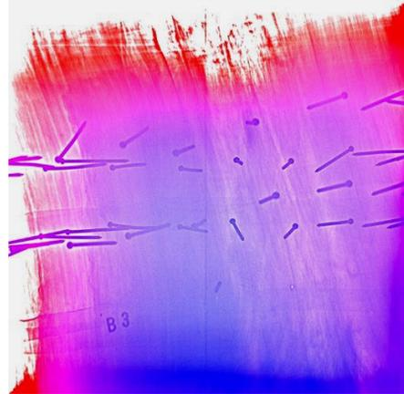
Abbildung 227: Dual-Energy aus 60 kV, 9 mA und aufgehärteter Strahlung mit 150 kV, 7 mA, 2 mm Cu (Seifert Isovolt 320)
