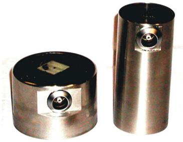
Abbildung 44: breitbandige Longitudinalwellenprüfköpfe von Krautkrämer mit einer Mittenfrequenz von 200 kHz. Links G 0,2 R (Durchmesser 79 mm), rechts G 0,2 GC 34 (Durchmesser 45 mm, Wandlergröße 34 mm, Prüfkopfhöhe 100 mm)
