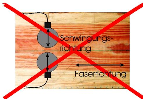
Abbildung 67: Polarisation der Transversalwellen senkrecht zur Faser ergibt sehr intensive Oberflächenwellen (A-Bild in Abbildung 69) für die Anwendung bei Ultraschallechomessungen nicht sinnvoll
