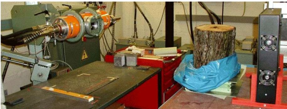
Abbildung 124: links stationäre Röntgenröhre Seifert Isovolt 320/13 mit Probekörper und rechts Agfa Flachdetektor (DirectRay am-Se, DDA digital detection array)
