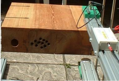
Abbildung 90: Messung mit luftgekoppeltem Ultraschall an Probekörper P2 aus Kiefer (36 cm x 20 cm x 9,5 cm) aus dem halben Kern geschnitten; hoher, nahezu rissfreier Kernholzanteil, Bohrungen zur Simulation von Innenfäule
