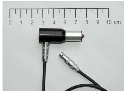
Abbildung 45: Punktkontaktprüfkopf für Longitudinalwellen: LD 120 mit 120 kHz Mittenfrequenz; für Transversalwellen: TD 20 oder TR 1802 mit 55 kHz Mittenfrequenz von ACSYS (ohne Koppelmittel)
