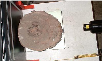
Abbildung 131: Draufsicht der Röntgenaufnahmeanordnung einer trockene Kiefernholzscheibe (links Detektor, rechts Blitzröhre).
