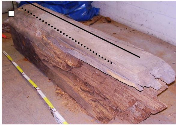
Abbildung 205: Abbildung links um 180° gedreht, Rückwandbereich für Messlinie in Bauteilmitte und am linken Bauteilrand. Geschädigter Bereich deutlich anhand des Würfelbruchs zu erkennen. Kleiner weißer Würfel dient zur besseren Orientierung.
