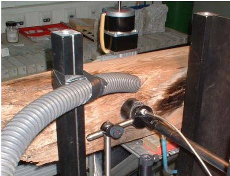
Abbildung 222: Messung mit LIBS an Probekörper BER1 mit Verunreinigung in einem Riss
