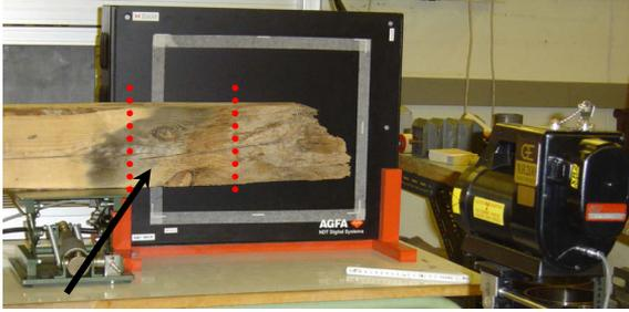
Abbildung 215: Messaufbau mit Flachdetektor und Blitzröhre bei der Untersuchung von Probekörper BER1, dargestellte Röntgenaufnahmen zeigen Bereich rechts neben der gepunkteten Linie
