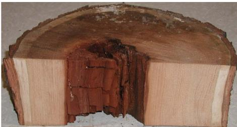
Abbildung 135: aufgesägte, trockene Laubholzscheibe mit Kernfäule, hellem Frühholz und dunklem Spätholz der Jahrringe
