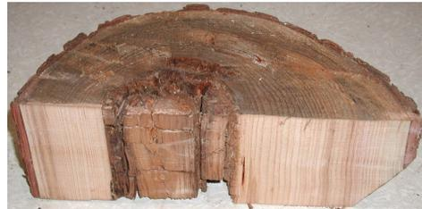
Abbildung 132: Kiefernholzscheibe (aufgesägt in Strahlrichtung der Röntgenmessung)
