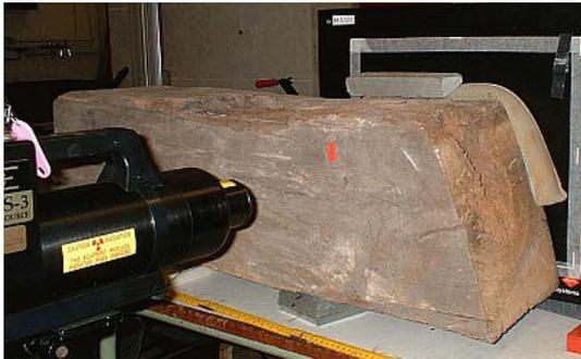
Abbildung 138: Messanordnung bei Durchstrahlung eines ausgebauten Eichenbalkens aus der Stadtkirche in Wittenberg
