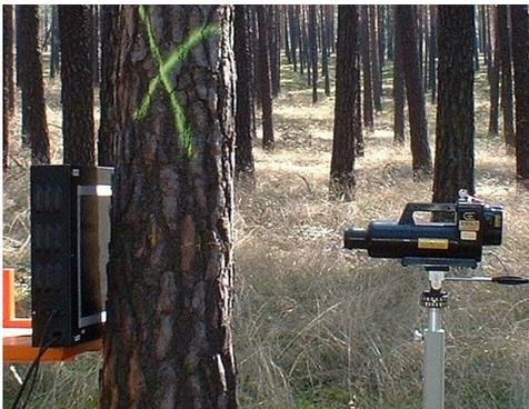
Abbildung 146: Messung mit Blitzröhre (300 kV) auf dem Feiversuchsgelände der BAM in Horstwalde an Kiefer, die zur Verifizierung nach der Messung gefällt werden soll
