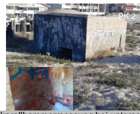
Probekörper (PK) für Rückprallhammermessung bei unterschiedlicher Oberflächenvorbereitung
